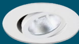
inklusive universell dimmbaren Vorschaltgerät, IP65, schwenkbar, 220-240 V, 8,4 W, 3000 K, 1010 lm, D 83, H 48,5, LA 68, ET45
