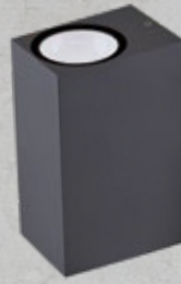
3243524. Anthrazit, beidseitiger Lichtaustritt, 100-240 V, 2 x 3 W LED, IP54, inkl. Netzgerät, 3000 K, 2 x 145 lm, H 95, L 150, B 68 € 125,70
