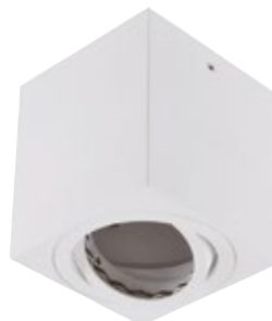
2616424 Weiß, schwenkbar, Energiesparlampe, max. 11 W, GU10, IP20, H 90, L 80, B 80 € 93,60
