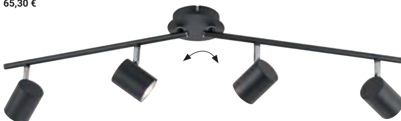
4609708. Anthrazit, schwenkbar, 4 x GU10, 5 W, 3000 K, H 144-160, B 765, L 834, A 160 65,30 €
